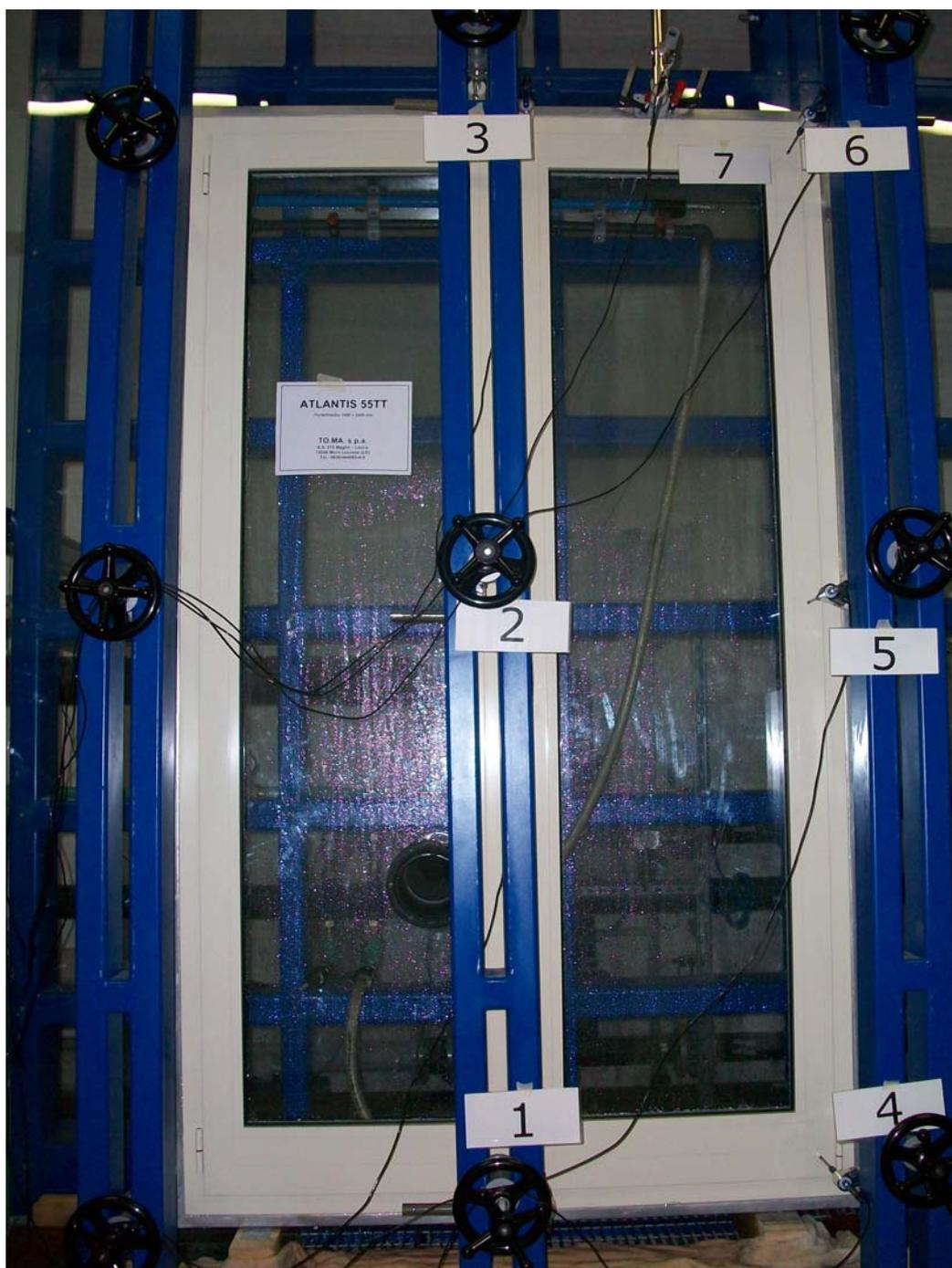
Foto 4: Campione durante la prova di resistenza al vento (prova di deformazione)
