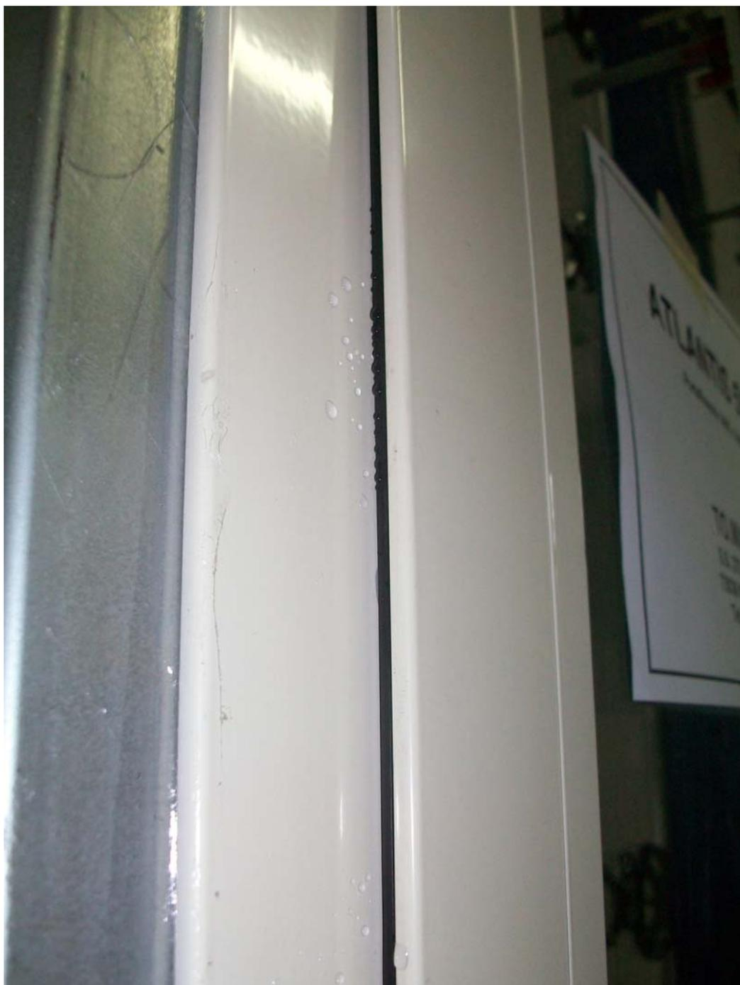
Foto 3: Perdita del campione sottoposto a prova durante la prova di tenuta all'acqua
