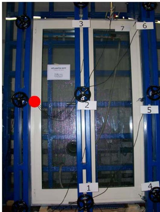
Foto 5: Posizione della rottura del campione durante la prova di resistenza al vento (prova di sicurezza)
